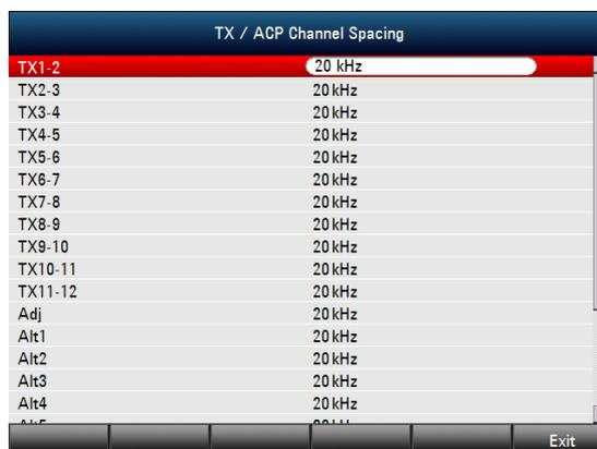
Bei der Durchführung von Messungen für Mehrträgersignale können Sie das Raster der Übertragungskanäle zueinander festlegen. Standardmäßig geht der R&S FSH von einem identischen Raster zwischen allen Übertragungskanälen im System aus. Deshalb wird das Raster, das Sie für die ersten beiden Übertragungskanäle angeben, automatisch für alle anderen Übertragungskanäle übernommen.
