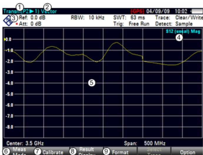
Nach dem Einschalten des Mitlaufgenerators zeigt die Statusanzeige UNCAL an. Dies dient zum Hinweis, dass die Messung mit dem Mitlaufgenerator unkorrigiert ist. Die Pegelachse zeigt er in der relativen Einheit dB an. Neben den Pegelwerten zeigt er die 0-dB-Referenz an. Diese entspricht einem Referenzpegel von 0 dBm im Spektralanalysatorbetrieb (= nominaler Ausgangspegel des Mitlaufgenerators).
